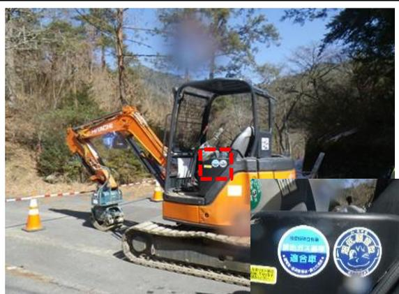
写真4-1-43 排出ガス対策型、低騒音型建設機械の採用（一例）
