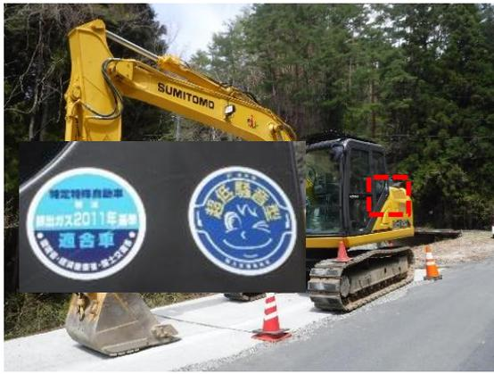
写真4-1-34 排出ガス対策型、低騒音型建設機械の採用（一例）
