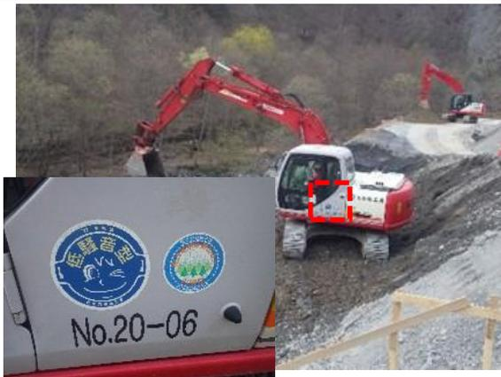
写真4-1-3 排出ガス対策型、低騒音型
