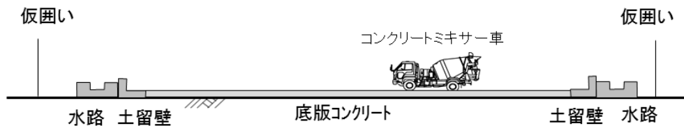
図 2-3-3(2) 山口下島地区発生土仮置き場における主な施工手順（底版コンクリート等設置）
