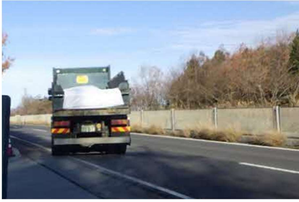
写真4-1-13-13 荷台への粉じん防止シートの敷設状況
