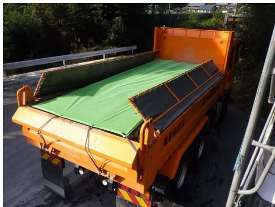
写真4-1-10-11 荷台への防じんシート敷設状況
