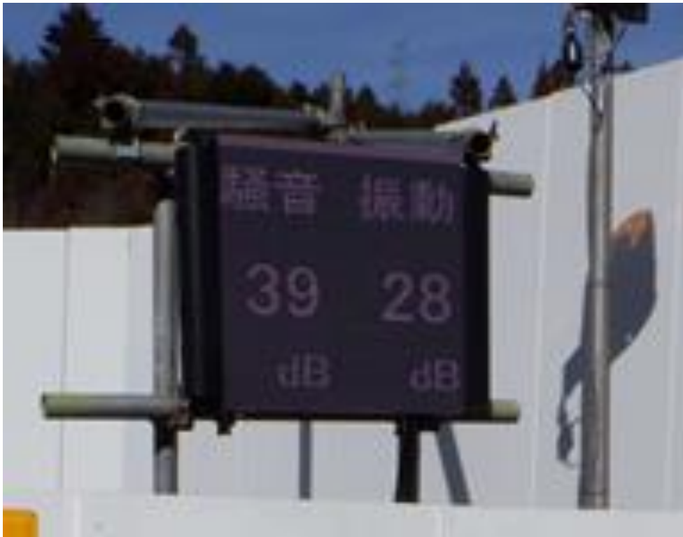
写真 参-3(12) モニター表示例 (07 長島トンネル、藤川高架橋)
