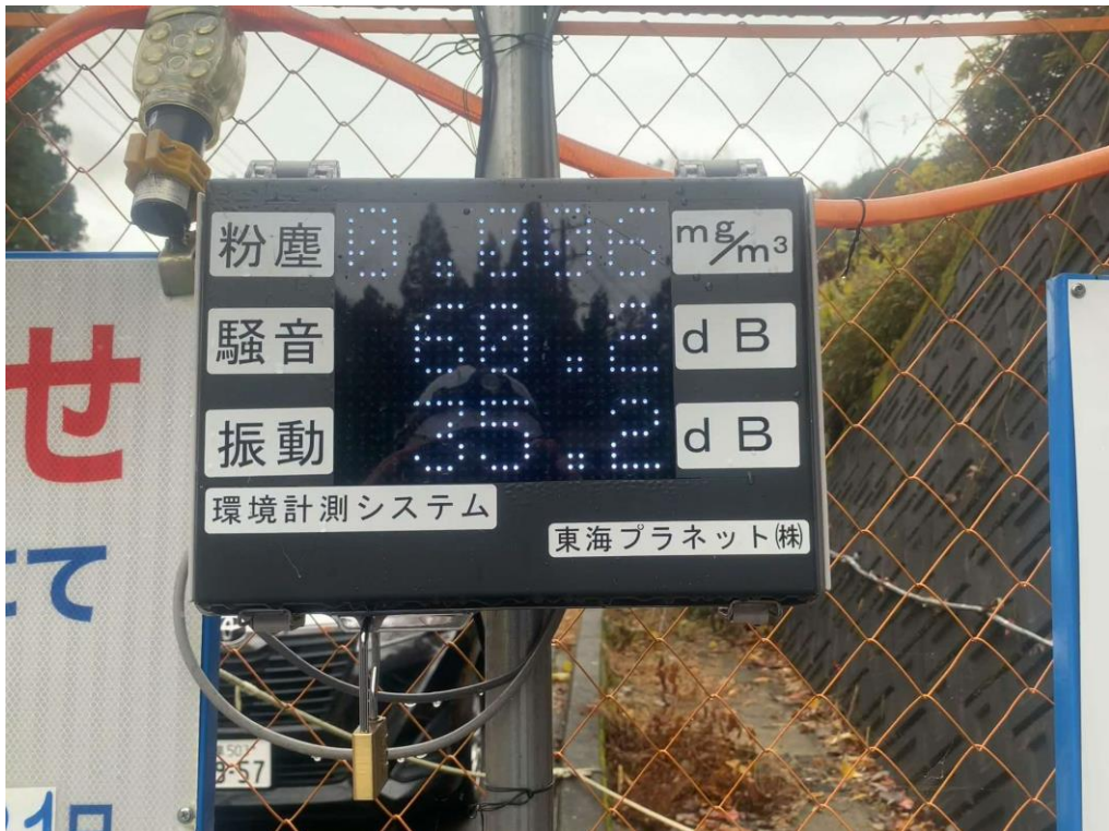
写真 参-3(15) モニター表示例 (09 美佐野工事施工ヤード)
