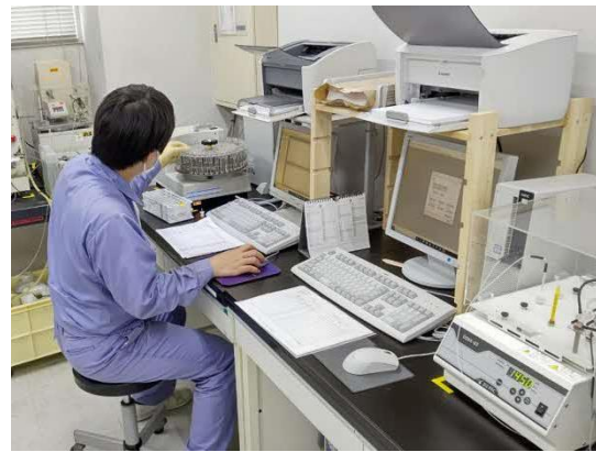
写真4-1-15-2-4 工事排水の 水質分析実施状況
