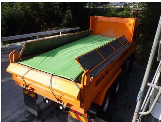
写真4-1-9-11 荷台への防じんシート敷設状況
