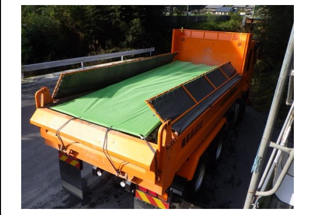
写真4-1-13-3-9 荷台への防じん及び浸透防止シート敷設状況
