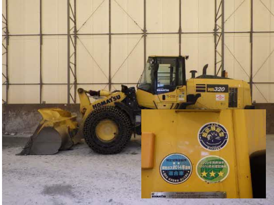
写真4-1-9-1 排出ガス対策型、 低騒音型建設機械の稼働
