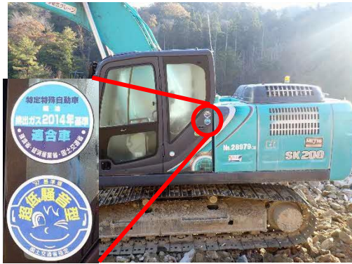
写真4-1-10-1 排出ガス対策型、 低騒音型建設機械の稼働
