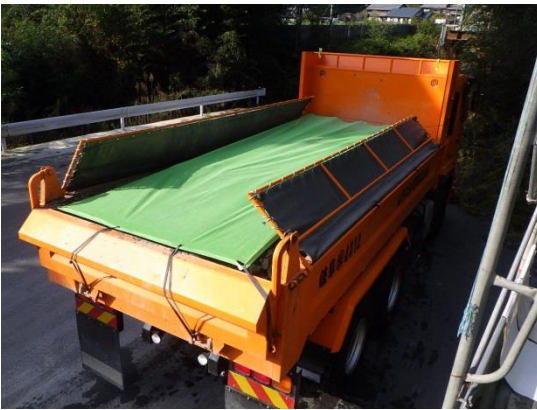
写真4-1-7-2-9 荷台への防じん及び浸透防止シート敷設状況
