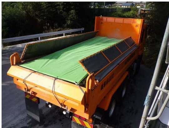
写真4-1-3-11 荷台への防じんシート敷設状況
