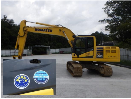
写真4-1-7-2-1 排出ガス対策型、 低騒音型建設機械の使用状況
