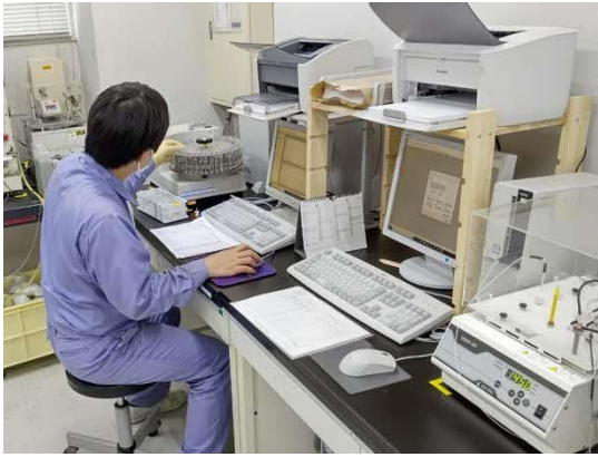
写真4-1-7-2-7 工事排水の水質分析実施状況
