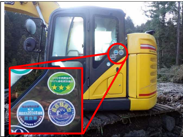
写真4-1-4-1 排出ガス対策型、 低騒音型建設機械の稼働
