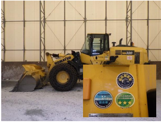
写真4-1-3-1 排出ガス対策型、 低騒音型建設機械の稼働
