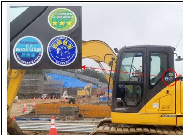
写真4-1-4-1 排出ガス対策型、 低騒音型建設機械の使用状況
