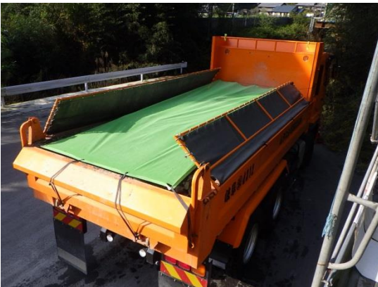
写真4-1-5-2-9 荷台への防塵及び 浸透防止シート敷設状況
