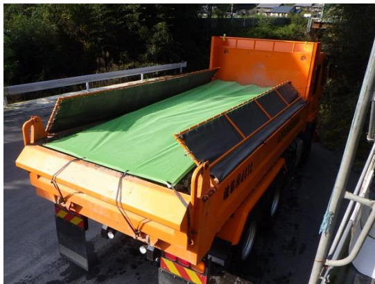
写真4-1-3-11 荷台への防塵シート敷設状況
