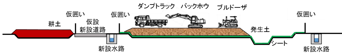
図 2-3-2(5) 中津川市内千旦林発生土仮置き場 A における主な施工手順 (発生土撤去)
