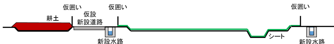
図2-3-2(3) 中津川市内千旦林発生土仮置き場Aにおける主な施工手順 (仮囲い設置・シート敷設)
