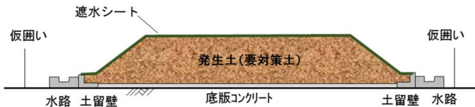
図 2-5(4) 山口下島地区発生土仮置き場における主な施工手順（仮置き）
