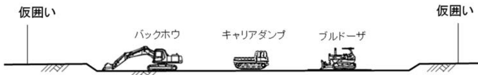
図 2-5(1) 山口下島地区発生土仮置き場における主な施工手順（耕土すき取り）
