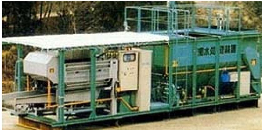
濁水処理装置の設置の例
