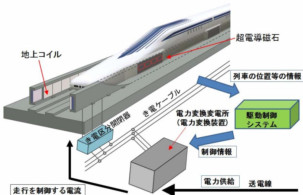
図 3-4-27 列車運行に係る設備の概要
