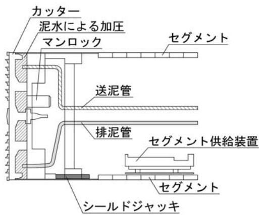
図 3-4-13 泥水式シールド機械（断面図）
