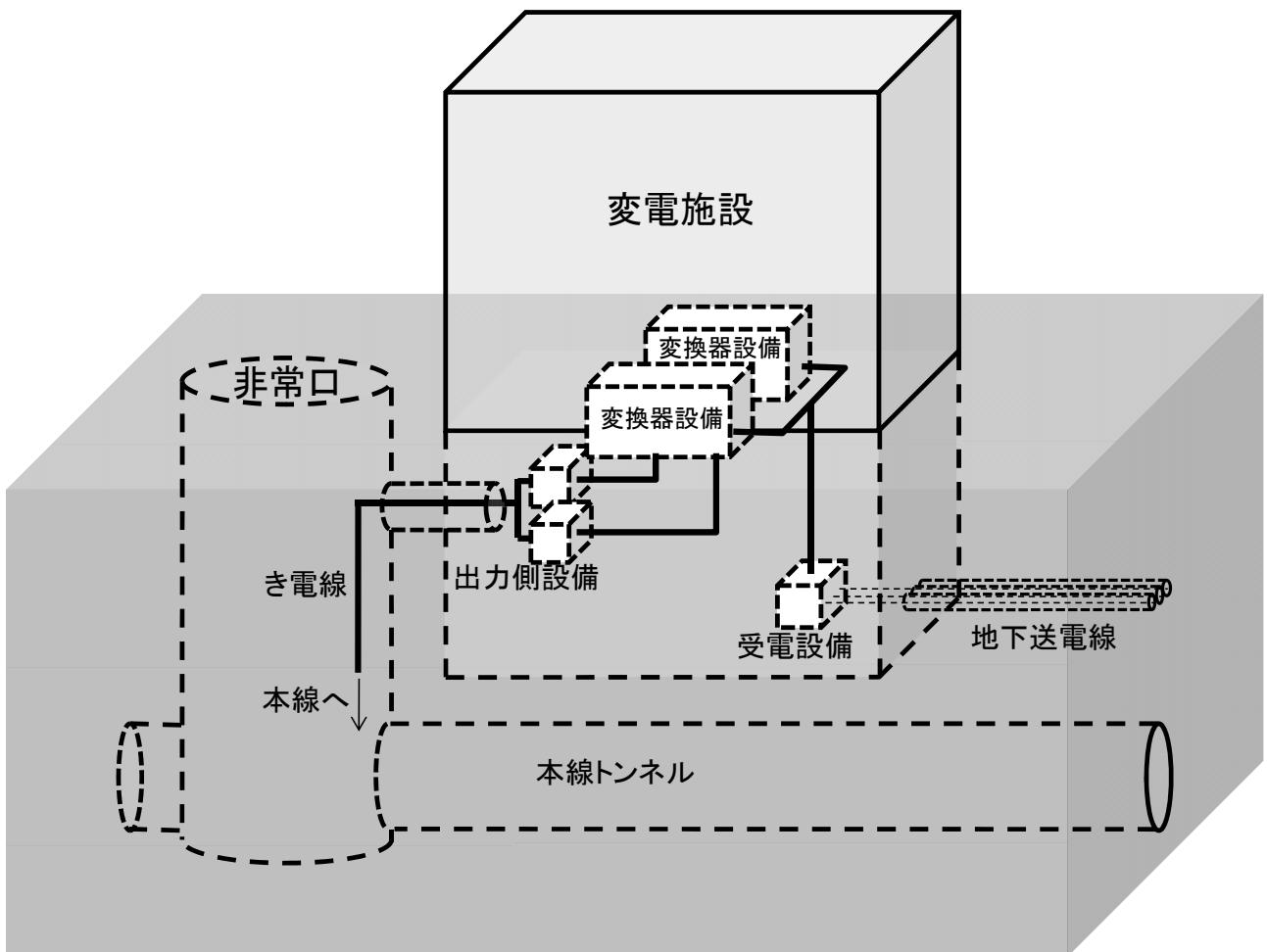
図 3-4-9 変電施設の概要
