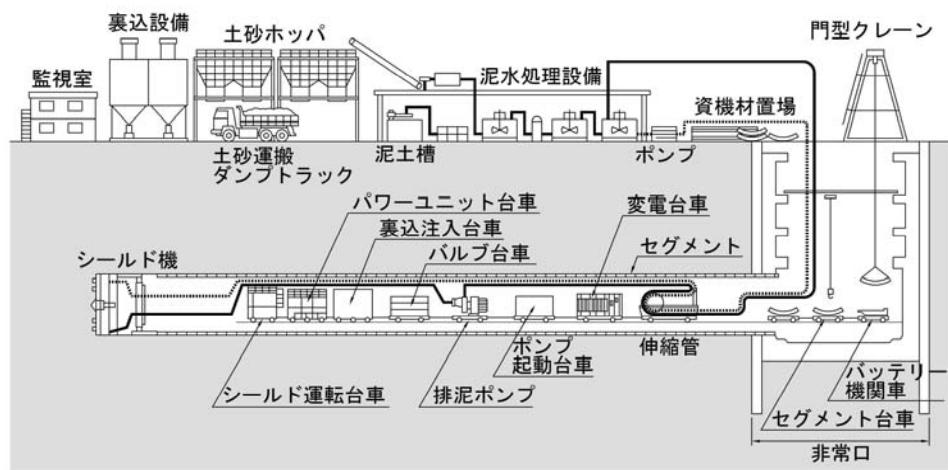
図 3-4-11 都市トンネル部における施工概要（泥水式シールド）
