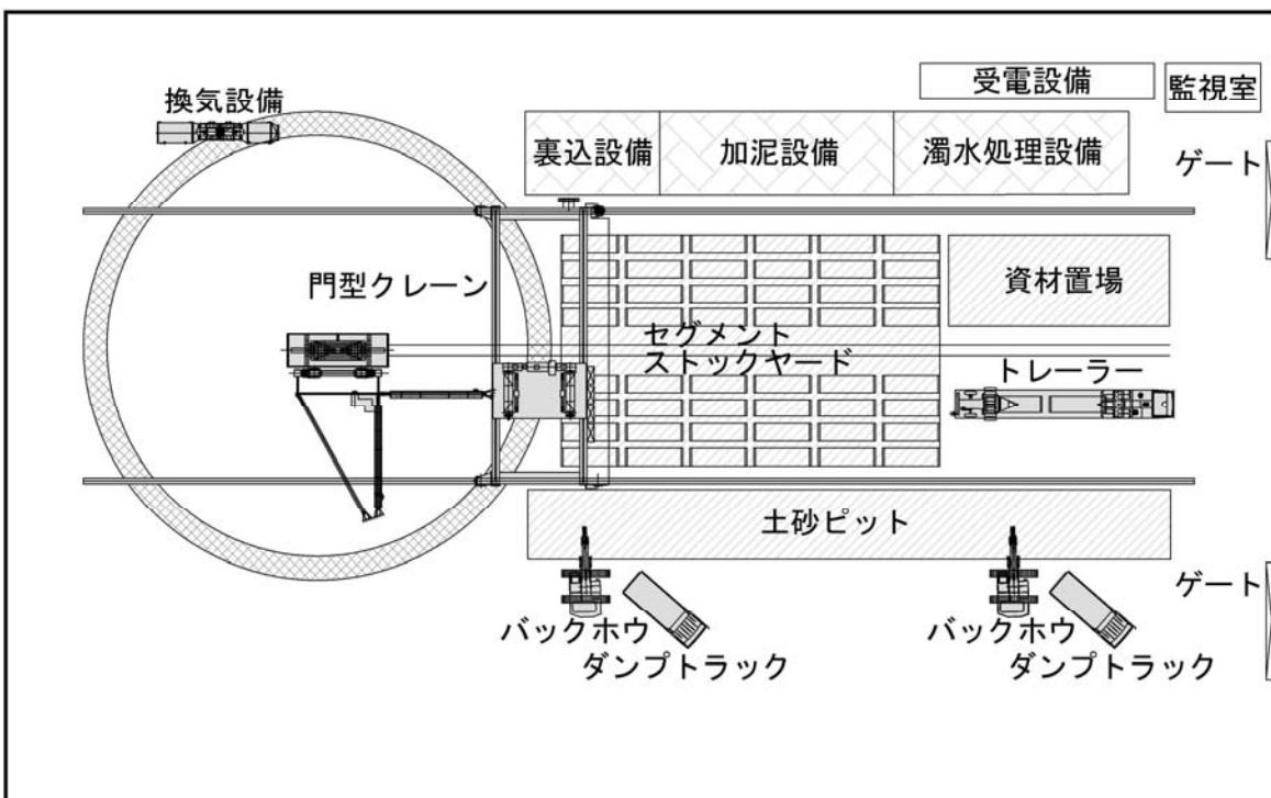
図 3-4-20 非常口の施工ヤードの概要（土圧式シールド工法によるトンネル施工時）
