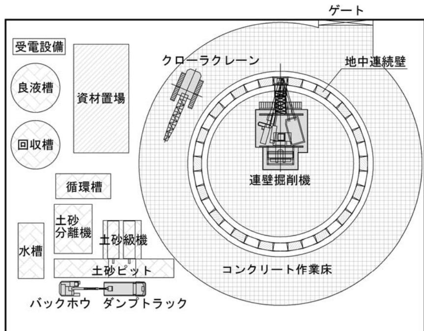
図 3-4-17 非常口の施工ヤードの概要（RC地中連続壁工法による非常口施工時）
