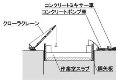
2 掘削・沈下・躯体構築(中期)
