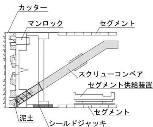
図 3-4-14 土圧式シールド機械（断面図）
