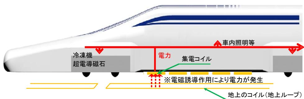
図 3-4-28 車上電源供給の概要
