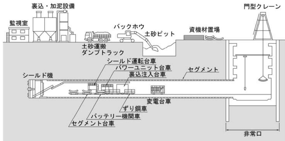
図 3-4-12 都市トンネル部における施工概要（土圧式シールド）
