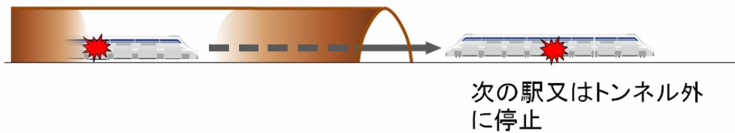
図 3-4-30 トンネルでの火災時の対応の概要
