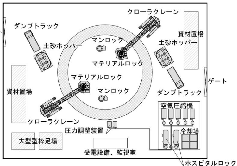
図 3-4-18 非常口の施工ヤードの概要（ケーソン工法による非常口施工時）
