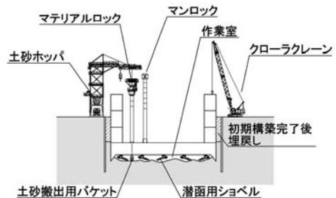
3 掘削・沈下・躯体構築(後期)
