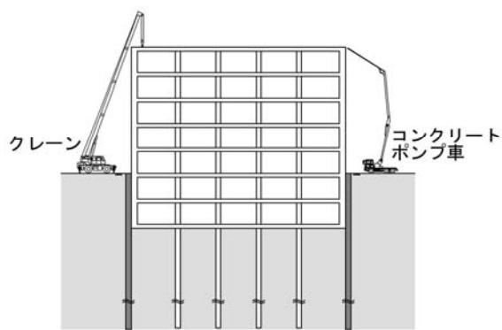
図 3-4-21 変電施設における施工概要
