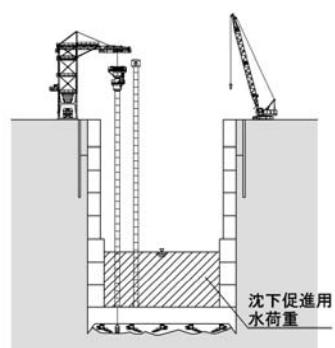
4 中埋コンクリート打設、ケーソン設備解体、鋼矢板引抜き
