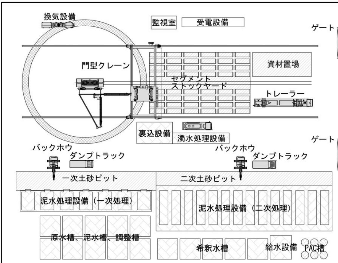
図 3-4-19 非常口の施工ヤードの概要（泥水式シールド工法によるトンネル施工時）
