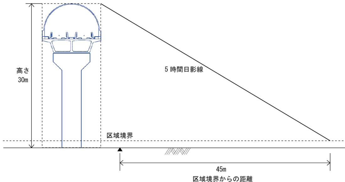
図 8-3-4-3 日影断面予測図（高架橋）
