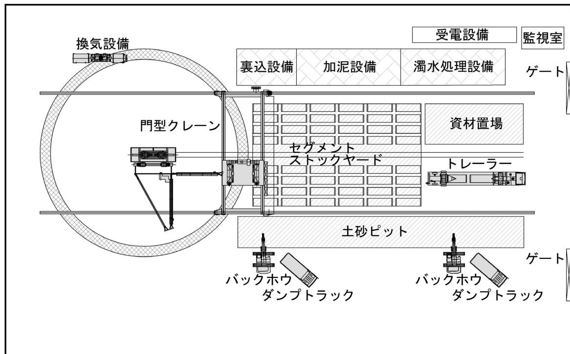
図 3-4-6-26 非常口の施工ヤードの概要（土圧式シールド工法によるトンネル施工時）
