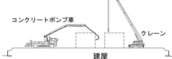
図 3-4-6-28 変電施設における施工概要
