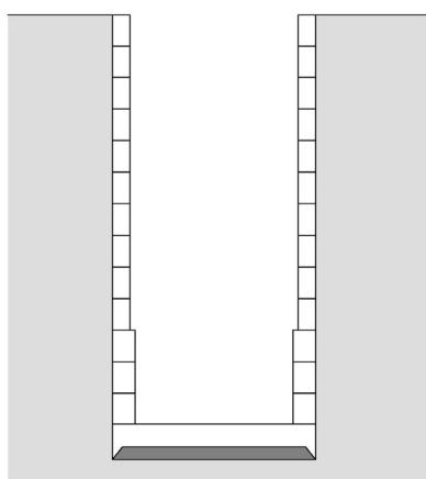
図 3-4-6-22 非常口の施工概要（ケーソン工法の場合）
