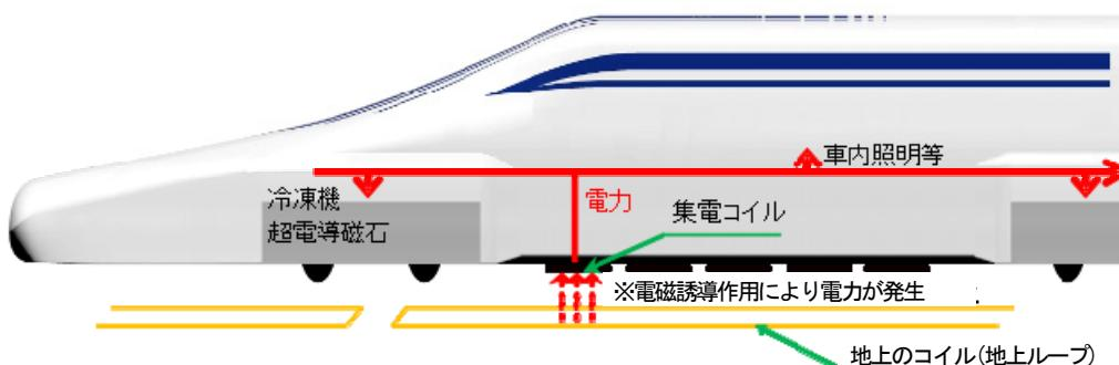
図 3-4-10-7 車上電源供給の概要
