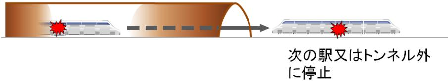
図 3-4-10-9 トンネルでの火災時の対応の概要
