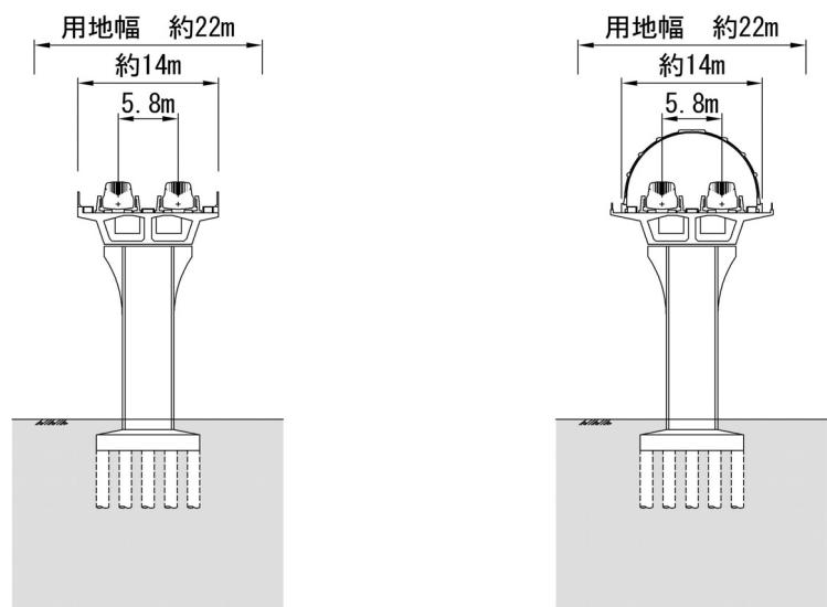
図 3-4-6-1 標準的な高架橋（桁式高架橋）の断面図
