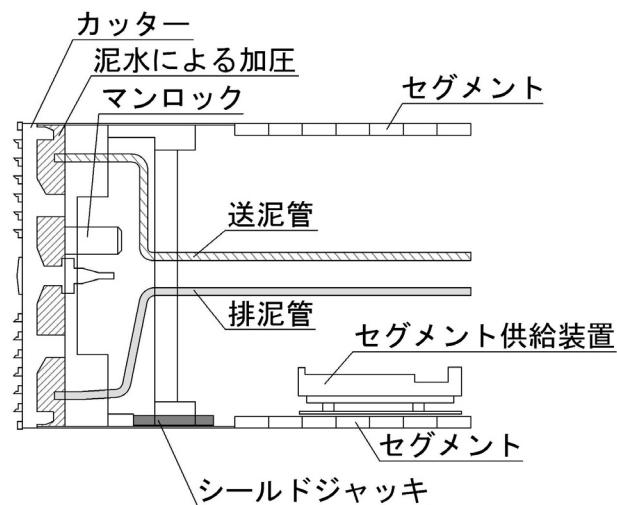
図 3-4-6-19 泥水式シールド機械（断面図）
