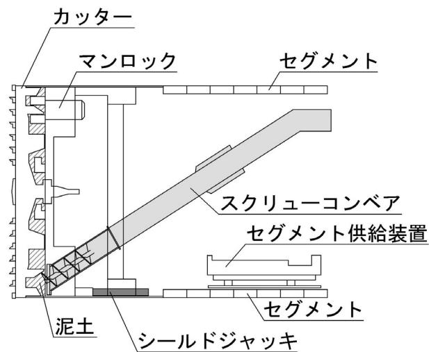
図 3-4-6-20 土圧式シールド機械（断面図）
