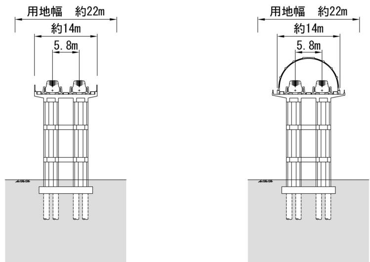
図 3-4-6-2 標準的な高架橋（新形式高架橋）の断面図
