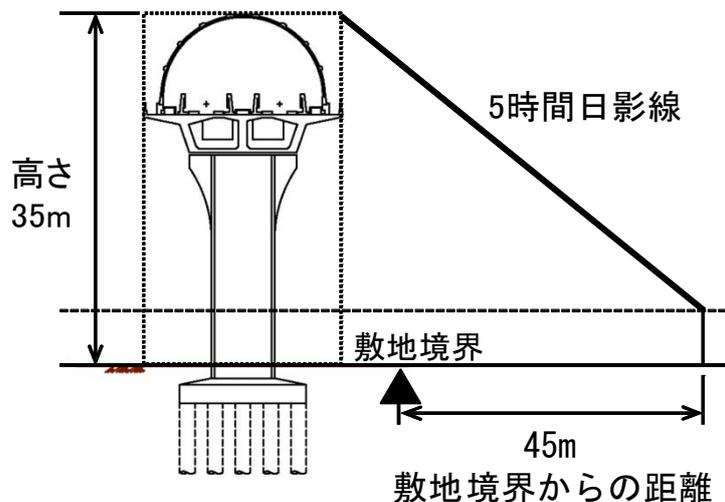
図 8-3-4-1 日影断面予測図（高架橋）
