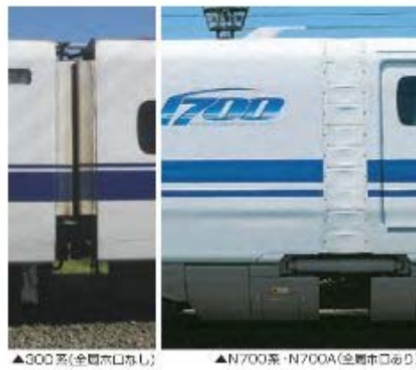
図 19-3-4 車両の平滑化による走行抵抗の低減の一例
