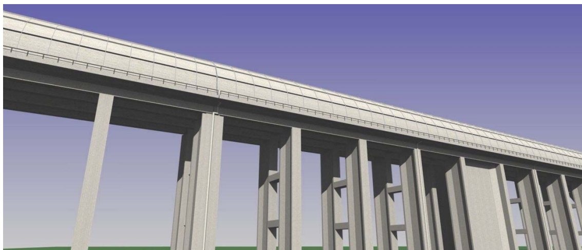
図 17-1-2 新形式高架橋（防音防災フード部）
