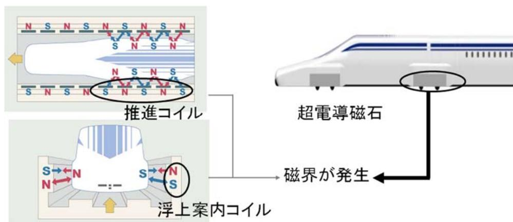
図 13-9-4 超電導リニアによる磁界の発生源
