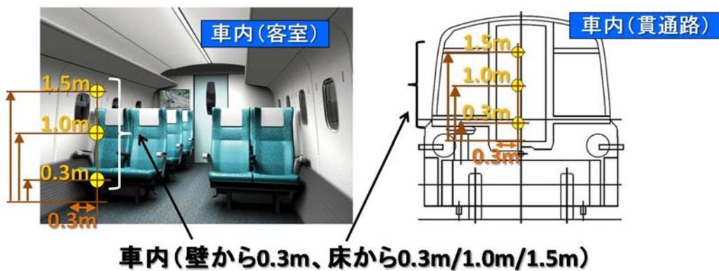
図 13-5-3 車内の磁界の測定箇所
