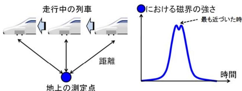
図 13-9-5 走行中の列車から発生する磁界のイメージ(超電導磁石が 1 つ通過する場合)
