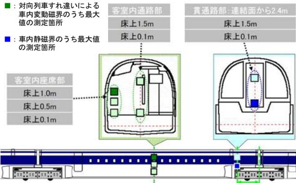
図 13-5-6 車内の磁界の測定箇所
