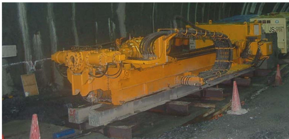
図 7-4-2 先進ボーリングマシン
