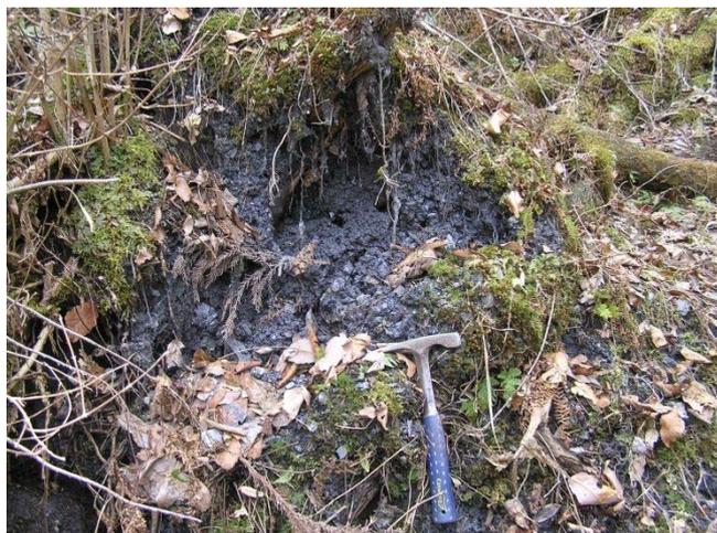
写真 9-1-3-6 中央構造線東側の地すべり土塊の土質状況。黒色片岩礫からなる礫混じり土。非常に脆弱である
