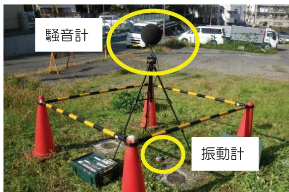
騒音・振動調査の例
