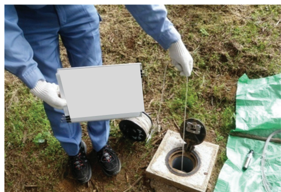
地下水位調査の例
