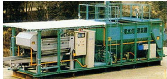
濁水処理装置の設置の例
