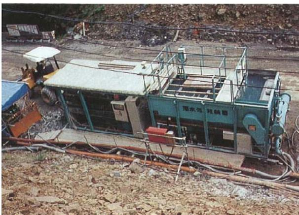
図 16-2-4 汚濁処理施設の例
