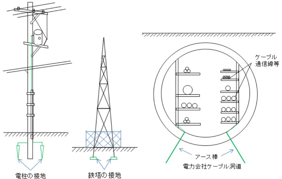
図 4-1-2 市中に存在する接地設備例
